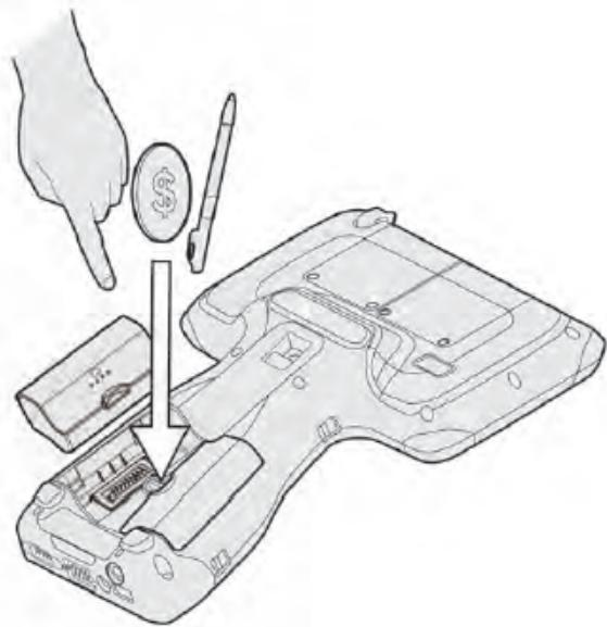
2. バッテリーを挿入し、平らな端が2つ目のバッテリー開口部に合うまでバッテリーラッチを180°回します。
